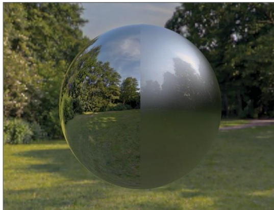
그림 2: 모든 조명 모델에 실제와 같은 환경을 추가할 수 있고, 역방향 광선 추적으로 만들어진 휘도 이미지를 쉽게 생성할 수 있습니다.
