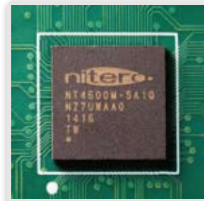
図1：Nitero NT4600：業界初のモバイル・アプリケーション向けIEEE 802.11ad SoC
