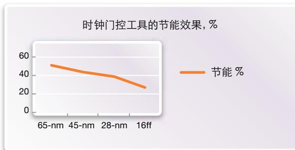
图2. 时钟门控工具的节能效果
